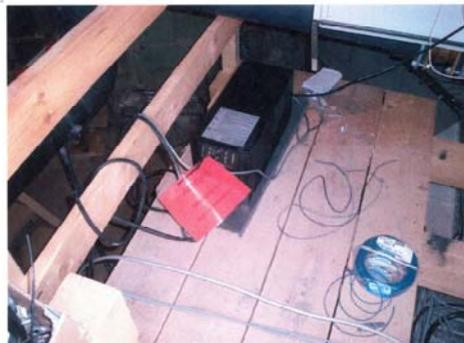
**Bild 3:** Prüftechnik wurde über eine bauseits gestellte USV-Einheit versorgt.
