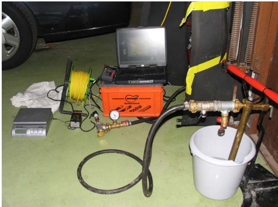
**Figur 8: Einfache Prüfeinrichtung mit Hand-Füllpumpe, ergänzt mit elektronischem Drucksensor und Datenerfassungssystem, angeschlossen an EWS Verteiler in Garage.**
