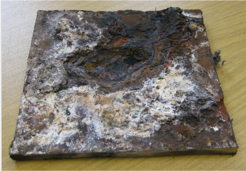
Bild K.5: Bodenblech (ursprüngliche Dicke 10 mm) von unten; Muldenkorrosion
